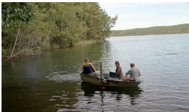
Fot. 1. Przetwornik stabilnie przymocowany do burty łodzi i skierowany pionowo w dół.
