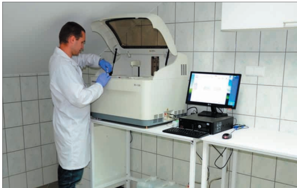
Fot. 3 Automatyczny analizator biochemiczny wykorzystywany do oznaczeń wskaźników biochemicznych w osoczu/surowicy krwi u ryb (fot. M. Hopko).
