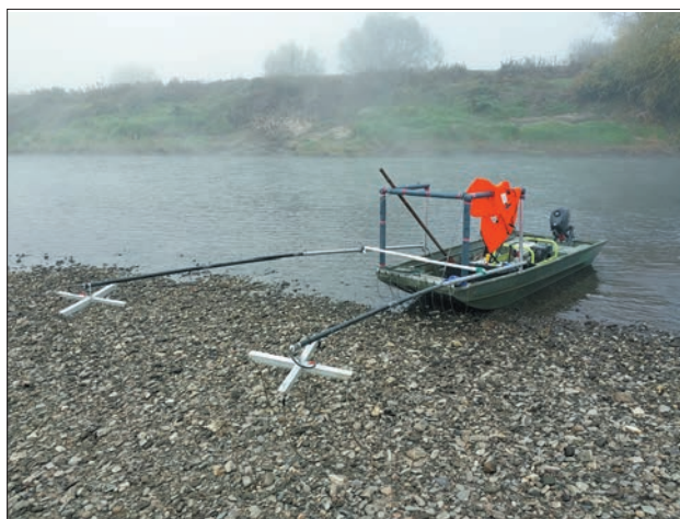
Fot. 1. Prototypowy zestaw do elektropołowu w dużych nizinnych rzekach testowany w 2024 roku.
