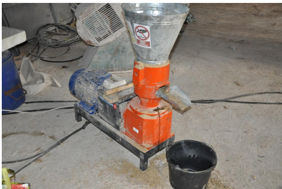
Fot 1. Granulator (peleciarka) wykorzystany do produkcji własnego granulatu.
