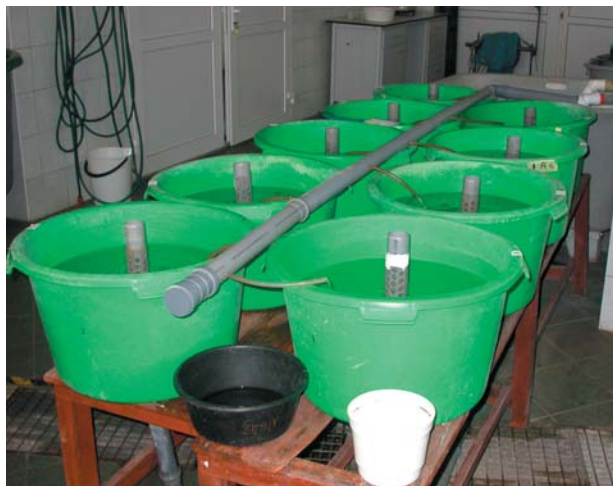
Fot. 1. Fragment obiegu recykulacyjnego z basenami podchowowymi.
