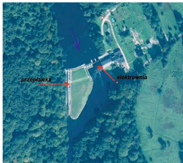
Rys. 2. Rzut przegrody i lokalizacja przepławki (Google Inc.).
