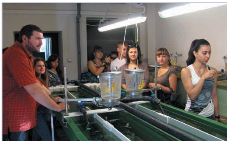
Fot. 2. Studenci zapoznają się z pracą modelowego obiegu zamkniętego do badań zachowań narybku jesiotra.
