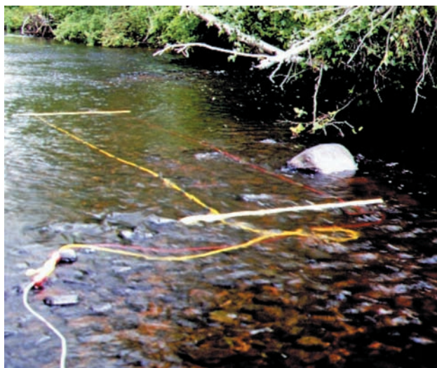
Rys. 1. Pętla połowowa według Bain i in. (1985) jest rozkładana na ok. 20 minut przed elektrołowem, co pozwala rybom na powrót po zaburzeniach związanych z instalacją pętli.
