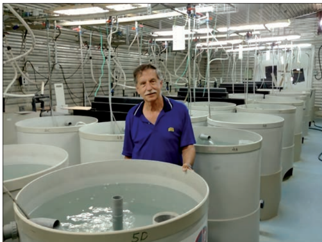
Fot. 3. Obiekty programu akwakultury w Volcani Center, Agriculture Research Organization (ARO), do eksperymentów z rybami w celu monitorowania właściwości wody (temperatura, tlen, amoniak itp.) za pomocą zautomatyzowanych systemów.
